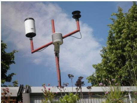
Das Smart Home Lab ist mit einem Gründach und begrünten Außenwänden der Fa. OptiGrün ausgestattet. Hier werden Untersuchungen zur Reduzierung der Feinstaubbelastung durch Fassadenbegrünung vorgenommen (u.a. von der Universität Wuppertal). Auf dem Wohnlabor befindet sich eine Wetterstation der TU Wien, die ebenfalls für die Auswertungen und Unterstützung der Modellbildung genutzt wird.
